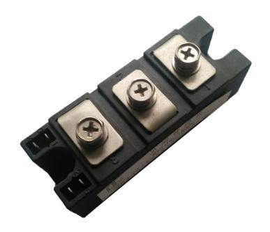
一种以硅单晶为基本材料的P1N1P2N2四层三端器件,创制于1957年,由于它特性类似于真空闸流管,所以国际上通称为硅晶体闸流管,简称晶闸管T□又由于晶闸管开始应用于可控整流方面所以又称为硅可控整流元件,简称为可控硅SCR□
