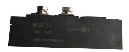
可控硅模块是有PNPN四层半导体构成的元件,有三个电极,阳极a□阴极K和控制机G所构成的。
